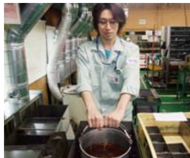
機能水を使用した時計部品の洗浄
