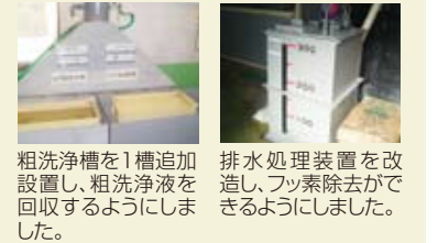
粗洗浄槽を1槽追加設置し、粗洗浄液を回収するようにしました。
