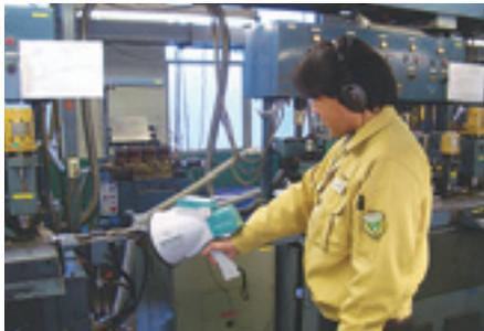
エアリークチェッカーによる空気漏れ検査
