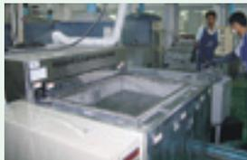
水系洗浄機による洗浄作業
