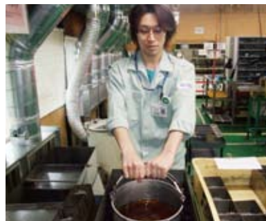
機能水を使用した時計部品の洗浄
