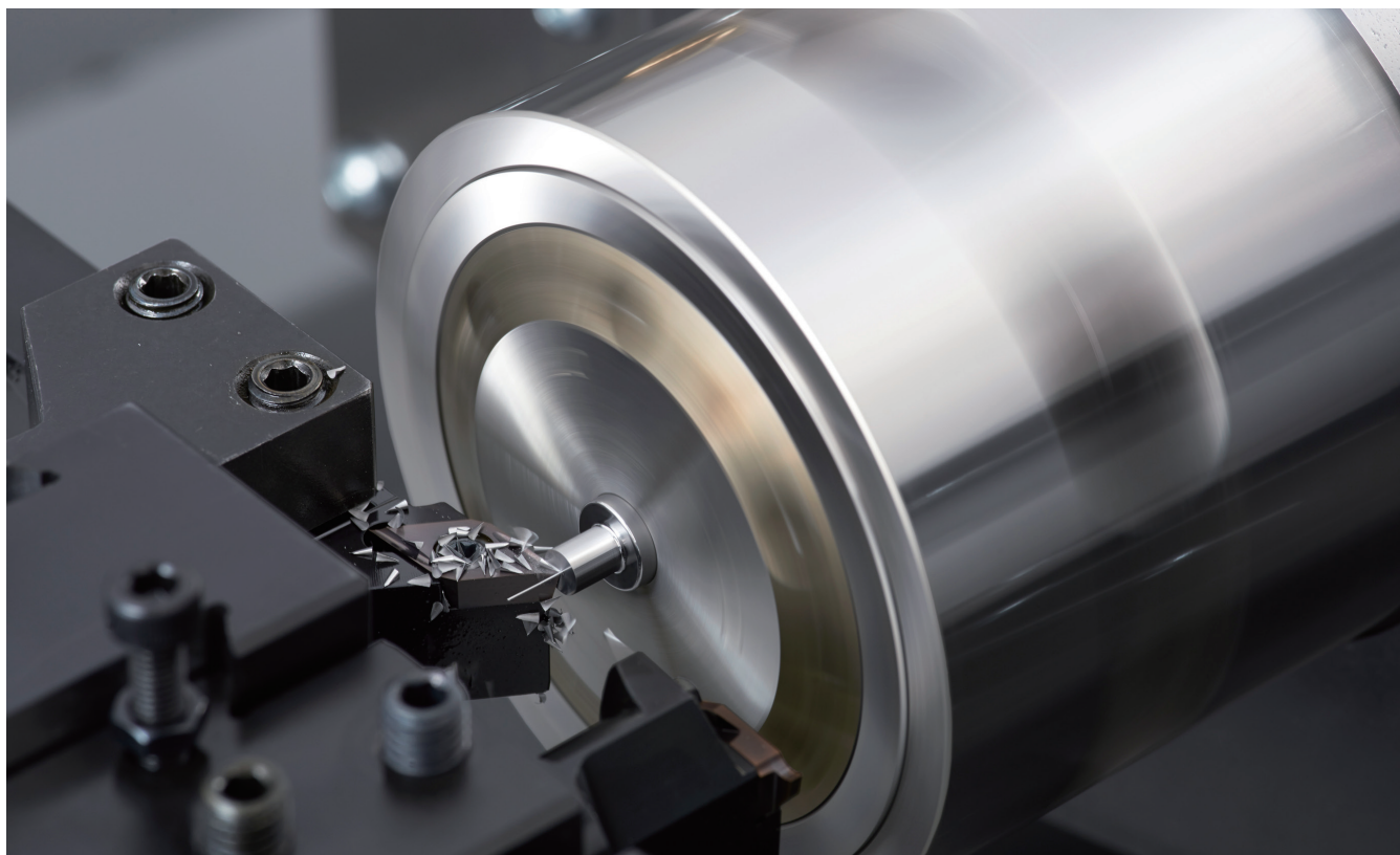
LFV(低周波振動切削)技術によるφ0.2mmを残す微細加工
